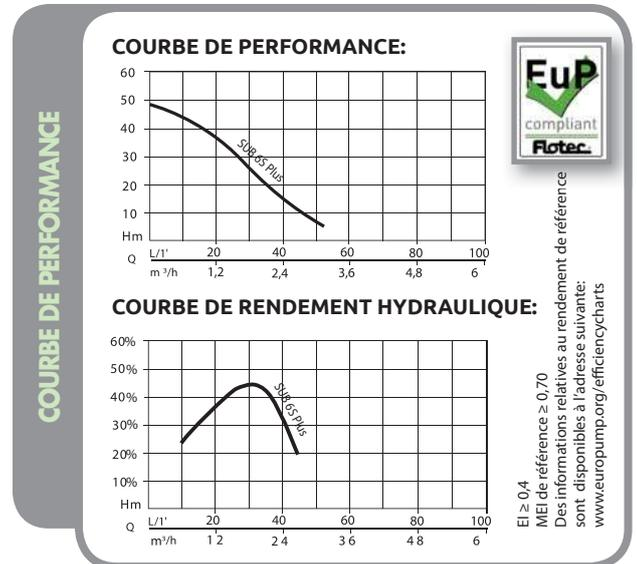
Pompe submersible pour puits, pour arroser et pour fournir de la pression à l'installation hydrique domestique. SUB 6S Plus est une pompe professionnelle avec corps de pompe, arbre et cage moteur en acier inox, qui permet de laisser la pompe en permanence immergée sans risques de corrosion. SUB 6S Plus est équipée avec une double garniture mécanique, pour une grande fiabilité, une réduction de l'entretien et un usage prolongé dans le temps.
