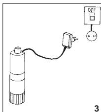
**E** Conecte la electrobomba a la red mediante un interruptor omnipolar (que interrumpe todos los hilos de alimentación) con una distancia de apertura de los contactos de al menos 3 mm.
