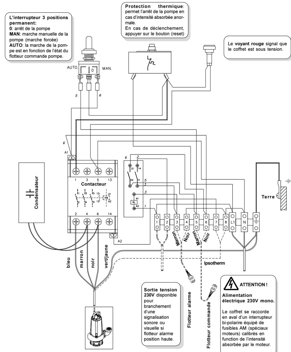
Bornes 7 et 8: Faire un pont si l'ipsotherm n'est pas raccordé.
