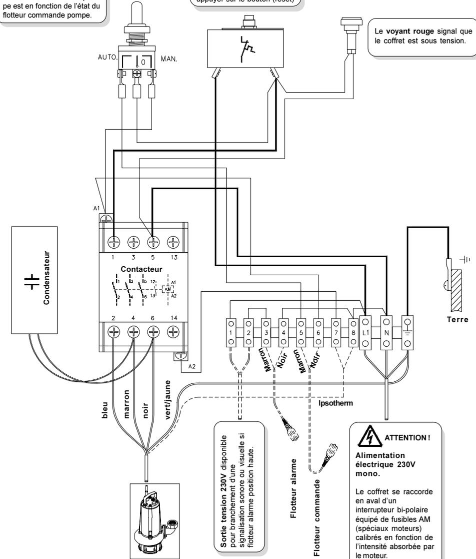
Sortie tension 230V disponible pour branchement d'une signalisation sonore ou visuelle si flotteur alarme position haute.
