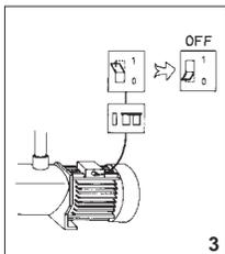
E Conecte la electrobomba a la red mediante un interruptor onnipolar (que interrumpe todos los hilos de alimentación) con una distancia de apertura de los contactos de al menos 3 mm.
