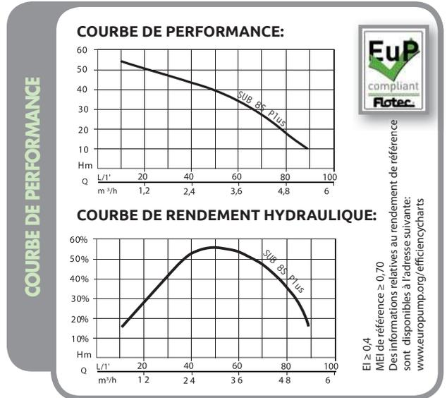
Pompe submersible pour puits, pour arroser et pour fournir de la pression à l'installation hydrique domestique. SUB 8S Plus est une pompe professionnelle avec corps de pompe, arbre et cage moteur en acier inox, qui permet de laisser la pompe en permanence immergée sans risques de corrosion. SUB 8S Plus est équipée avec une double garniture mécanique, pour une grande fiabilité, une réduction de l'entretien et un usage prolongé dans le temps
